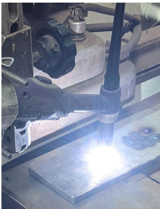
Fig. 5. Welding arc.
